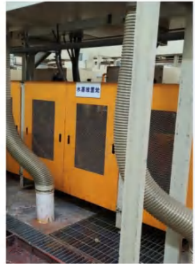
非密闭型印刷机密闭收集集气管
